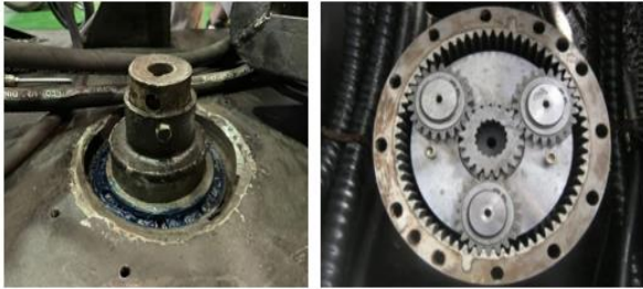
Gambar 17. Mekanisme swing dan planetary gear set
