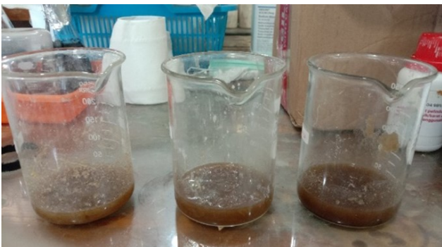
GAMBAR 4. Hasil asetilasi selulosa daun nanas (dari paling kiri ke kanan: sampel dengan rasio anhidrida asetat terhadap selulosa 2:1; 2,7:1; 3,4:1).
