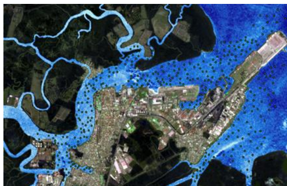
Gambar 8. Persebaran titik uji ketelitian dengan Navionics Nauticalchart.
