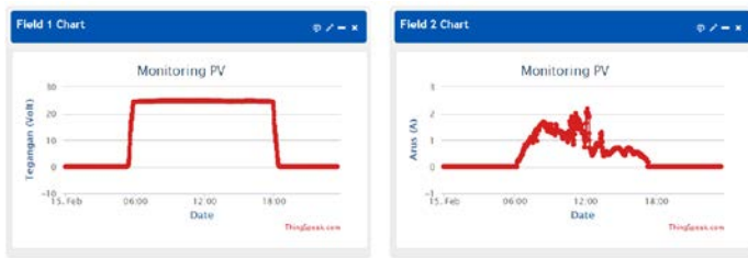
Gbr. 10 Tampilan monitoring tegangan dan arus.
