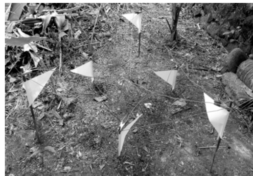
Gbr. 9 Foto pengukuran resistans pentanahan satu batang pentanah dengan elektrode sangkar delta batang penyusun sisi delta 1 meter.
