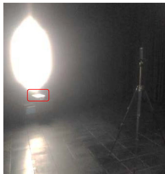
Gbr. 3 Pengukuran nilai luminans aktual pada kertas putih.
