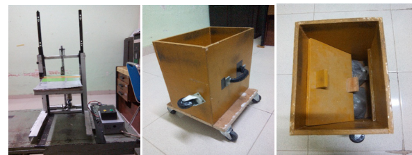
(a) (b) Gambar 1. Mesin lifting-lowering (a) dan kotak beban (b) Sumber : Dokumentasi Peneliti
