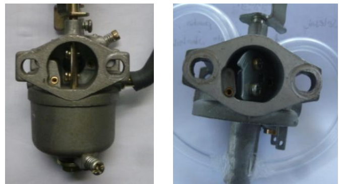
Gambar 1. Karburetor bensin (kiri) dan karburetor biogas (kanan)
