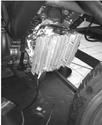
Gambar 9. Posisi pemasangan konstruksi TEG pada knalpot sepeda motor.
