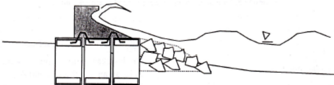
Gambar 4. Tembok Laut dengan Wave Reflector
