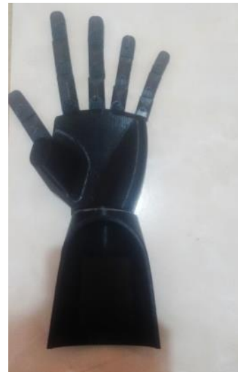
Gambar 4. Pembuatan prototipe menggunakan 3D printing
