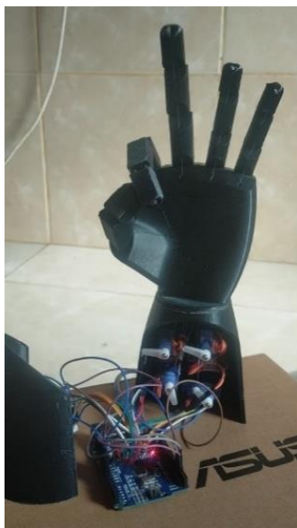
Gambar 7. Hasil akhir tangan bionik
