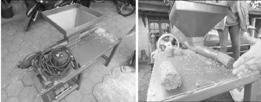
Gambar 4 Foto Alat/Mesin Pencetak Briket Kontinu dan Briket yang Dihasilkan dengan Dimensi p x l x t = 120 x 50 x 120 cm
