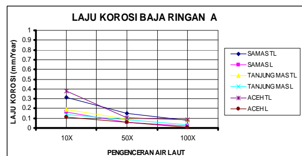
Gambar 3. Grafik Laju Korosi Baja Ringan A (TL: Tanpa Lapisan; L: Dengan Lapisan).
