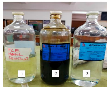
Gambar 6. 1) Hasil penyulingan limbah TCE praktikum kelarutan aspal dengan TCE, 2) Limbah praktikum kelarutan aspal dengan TCE, dan 3) TCE Murni (asli) yang belum tercampur dengan aspal.
