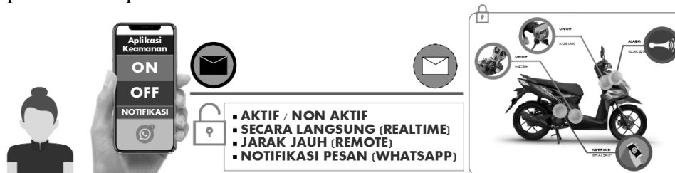
Gambar 4. Cara kerja sistem keamanan
