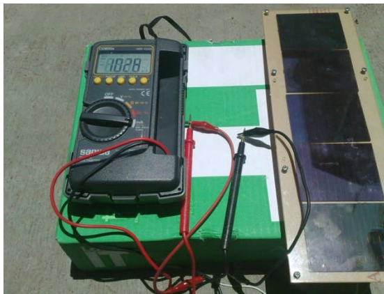
Gambar 10. Pengukuran Arus Listrik yang dihasilkan Solar Cell di bawah cahaya matahari, terukur 102,8 mA
