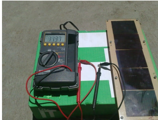
Gambar 9. Pengukuran Tegangan Solar Cell di bawah cahaya matahari, terukur 11,37 V
