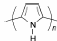
Gambar 1 Struktur molekul polipirol [2]
